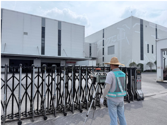
无组织废气现场监测
